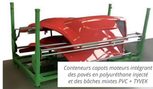
Conteneurs capots moteurs intégrant des pavés en polyuréthane injecté et des bâches mixtes PVC + TYVEK
